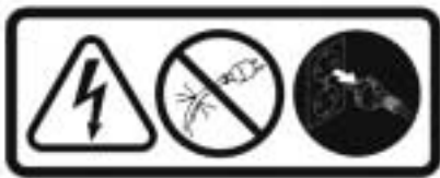
ETICHETTA DI TENSIONE PERICOLOSA – Situata sulla base.
