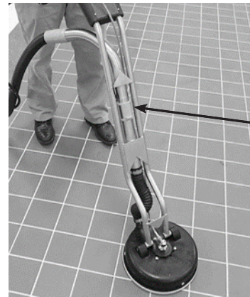
Cubierta del freno de aspiración
